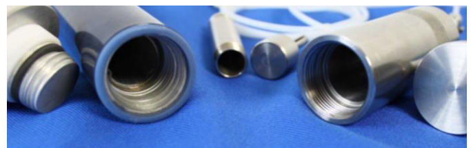
Beispiele für Prüfkörper mit extrem großen Kapseln zur Aufnahme des Indikatorstreifens
