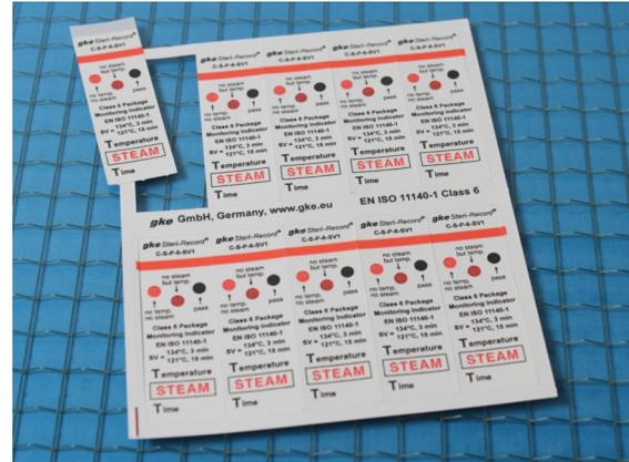
Abb. 2: Typ 6 Indikatoren gemäß DIN EN ISO 11140-1
