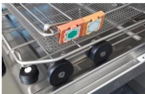
Die Abbildung links zeigt zwei Indikatoren nach dem Programmdurchlauf, rechts einen korrekt gelagerten und komplett abgewaschenen Indikator, links einen Indikator aus dem oben abgebildeten Schrank, der durch das ausgasende Desinfektionsmittel fixiert wurde und nicht mehr abwaschbar ist.
