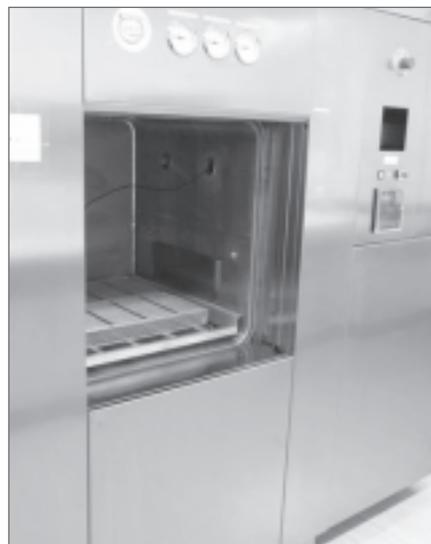
**Abb. 5:** Sterilisatorkammer 6, 6 mit 318 l Volumen
