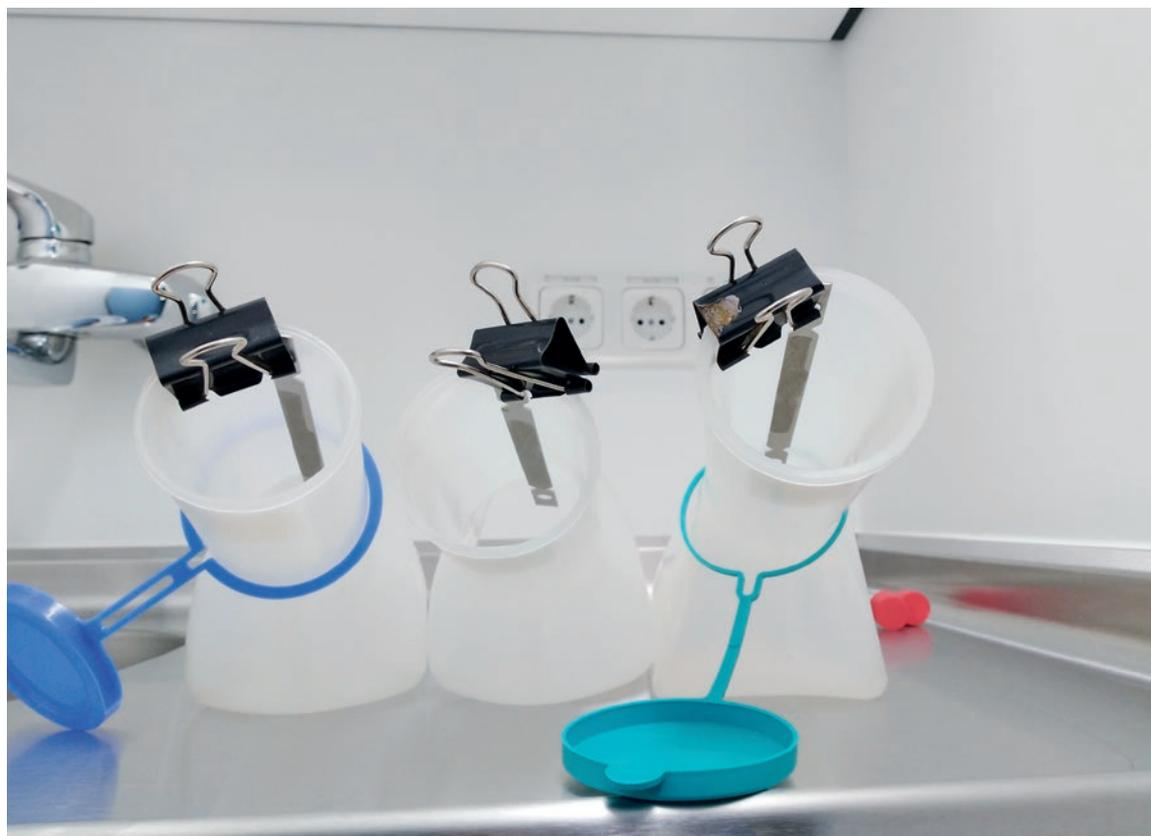
**Abb. 6:** Platzierung der Prüfkörper im Hals/Boden der Urinflasche (Quelle: Heike Kiesel B.A., kkm)
